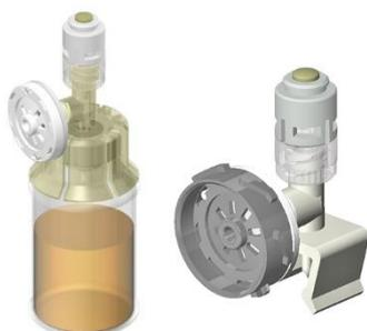
L'adaptateur de flacon ToxiSeal scelle hermétiquement le flacon. Son évent comporte deux membranes de filtration, soit un (1) filtre stérile hydrophobe de 0,2 micron et un (1) filtre à charbon actif qui absorbe les aérosols et les vapeurs de médicament. L'adaptateur de flacon ToxiSeal™ est compatible avec les adaptateurs pour injecteur-connecteur ProSeal™ et permet le transfert de solutés en système clos.
